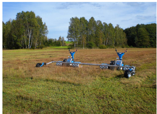
Abb. 7: Neu entwickelte Techniken ermöglichen die effizientere Bewirtschaftung von Nasswiesen. Beispielsweise montierbare Räumschilde/Heuschieber und funktionsgesteuerte Balkenmäher mit einer Arbeitsbreite von bis zu sieben Metern ermöglichen die Bewirtschaftung selbst von kaum noch begeharen Feuchflächen (Fotos: Uwe Kießling)
