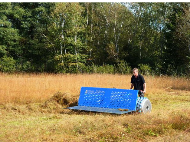
Abb. 7: Neu entwickelte Techniken ermöglichen die effizientere Bewirtschaftung von Nasswiesen. Beispielsweise montierbare Räumschilde/Heuschieber und funktionsgesteuerte Balkenmäher mit einer Arbeitsbreite von bis zu sieben Metern ermöglichen die Bewirtschaftung selbst von kaum noch begeharen Feuchflächen (Fotos: Uwe Kießling)
